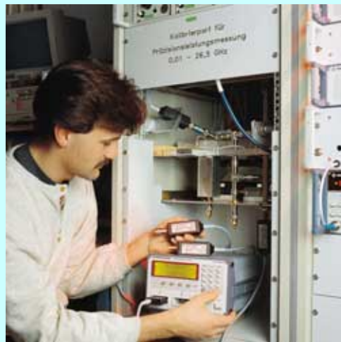
Die Kalibrierung der NRV-Z-Messköpfe ist auf die Normalien der Physikalisch-Technischen Bundesanstalt rückführbar
